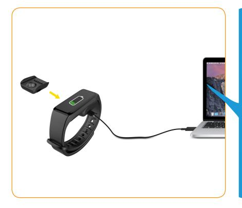
Avant d'effectuer la configuration initiale, nous vous invitons à recharger votre ZeFit³ pendant environ 1h30. Veillez à bien placer le chargeur magnetique aligné avec les terminaux de charge situés à l'arrière de la montre.
