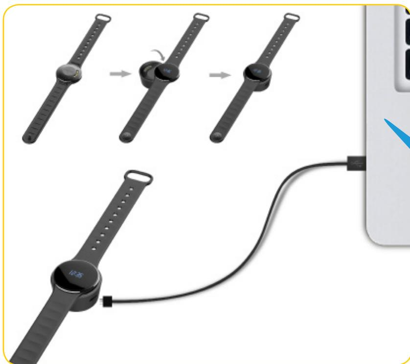
Avant d'effectuer la configuration initiale, nous vous invitons à recharger votre ZeCircle pendant environ 1h30. Veillez à bien placer le chargeur magnétique aligné avec les terminaux de charge situés à l'arrière de la montre. Brancher le port USB à une source d'alimentation. Un témoin de chargement apparaîtra à l'écran.
