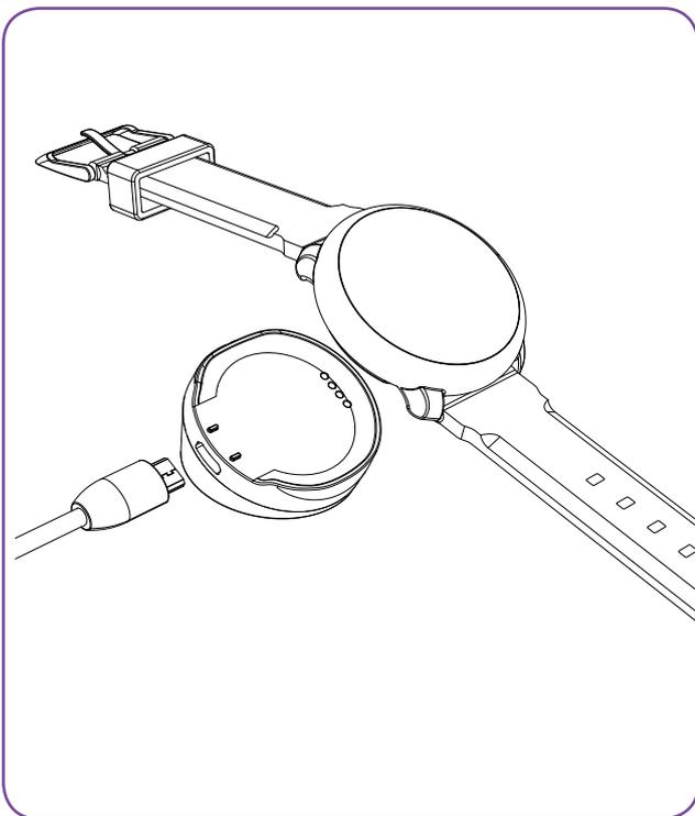
Avant d'effectuer la configuration initiale, nous vous invitons à recharger votre ZeRound pendant 2h. Assurez-vous que les bornes du socle soient bien alignées avec les contacts de charge situés à l'arrière de la montre. Brancher le port USB à une source d'alimentation. Un témoin de chargement apparaîtra à l'écran
